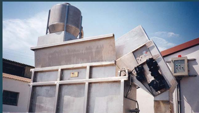
Tamizado en línea de matadero Tamis dans une ligne en abattoir Sieve in linia in a slaughter house
